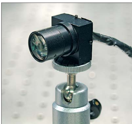
Versuchsmodell eines Pico-Beamers aus dem Forschungslabor Bilder: [5]
