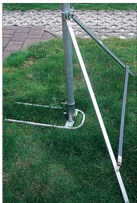
Bild 4: Ein Stativhalter (Tripod) nutzt den vorhandenen Mastfuß als drittes „Bein“. Die beiden Streben aus Boommaterial (20 mm x 1,5 mm, 1 m lang) enden am Erdboden auf Aluminium-Blechen. Das Querelement besteht aus Flachstahl 20 mm x 3 mm, 1 m lang. Die Verbindungen werden durch auf 135° gebogene und mit M5-Schrauben montierte Winkel realisiert.
