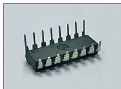
Bild 9: Ansicht einer gekürzten An- schlussreihe; beide Reihen des MAX3232 sind am Ende zu kürzen.
