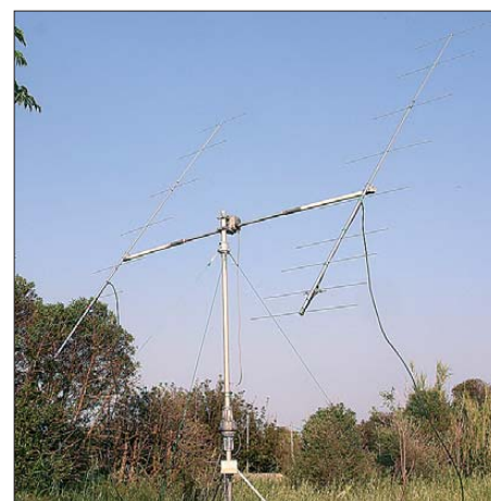
Bild 5: Die Anlage im „Betriebsmodus“ und in voller Schönheit; die Gesamthöhe über Grund beträgt 3 m. Mehr hilft bei EME-Betrieb ohnehin nicht und alles ist noch recht unauffällig und leicht. Gesamtmasse: 12 kg; Aufbauzeit mit etwas Übung: 1 h
