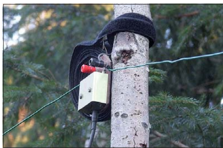
Dipol-Speisepunkt von DJ3AX im Einsatz Foto: K. Schönwitz
