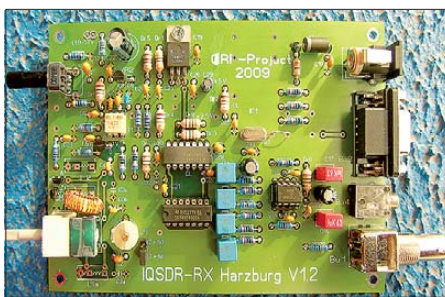
Leiterplatten-Prototyp des zukünftigen SDR für unser altes/neues Projekt „Bau ein Radio mit einem Kind“ Foto: qrpproject.de
