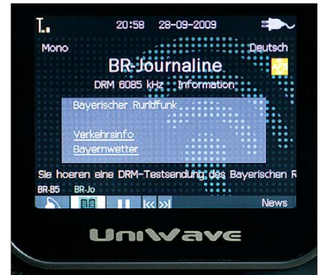
Bild 3: Der Bayerische Rundfunk sendet auf seiner Kurzwelle 6085 kHz im DRM-Datenstrom neben dem Hörfunkprogramm einen Textdienst mit Verkehrs- und Wetterinformationen. Foto: DL1ABJ
