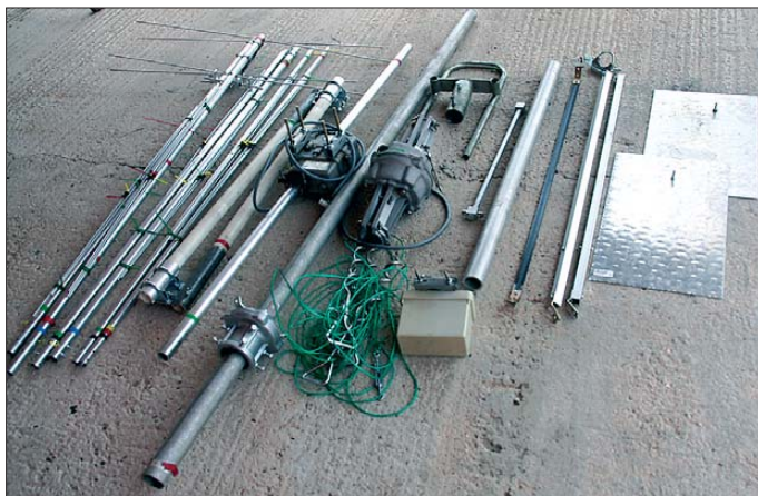
Bild 1: Die Anlage im „Transportmodus“ von links nach rechts: zusammengelegte Antennen, Glasfaserrohrstummel, mittleres Querrohr mit Vertikalrotor, oberes senkrecht Tragrohr mit Oberlager, Horizontalrotor, Kfz-Fuß, Abspannung mit Erdankern, Anpasstopf, Vorverstärker, unteres Tragrohr, Tripodelemente, Fußbleche
