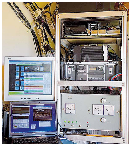
Der Blick in das Shack von SM1A offenbart es: Eine „dicke“ PA wie hier mit zwei GU74b sorgt auch für die nötige Feldstärke am anderen Ende des Funkkanals.
