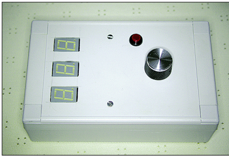
Bild 5: Die gesamte Elektronik ist in einem handlichen Plastikgehäuse untergebracht. Die Motordrehzahl lässt sich bequem auf der Frontplatte einstellen.
